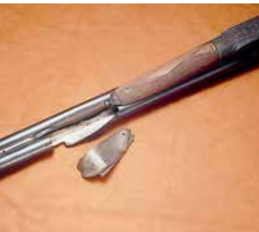
Laufsprengung als Folge einer nicht funktionssicheren Waffe
